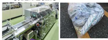
包装資材のシート交換時に機械を停止させるため端材が出る。交換時期を予測し、休憩時間を兼ねることで機械停止回数と端材排出量の削減を検討。一定の効果が出た。
